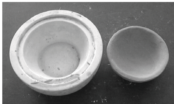
写真2 本実験組成の鑄込み成形
