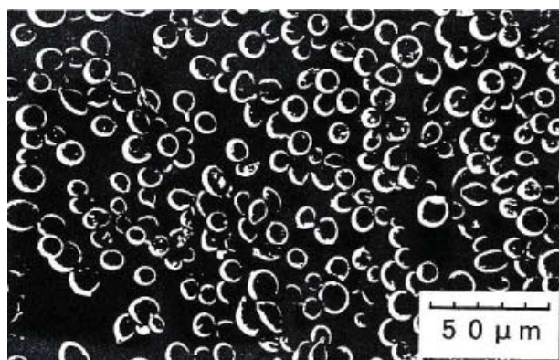
図5 超微粒シラスバルーンの電子顕微鏡写真
